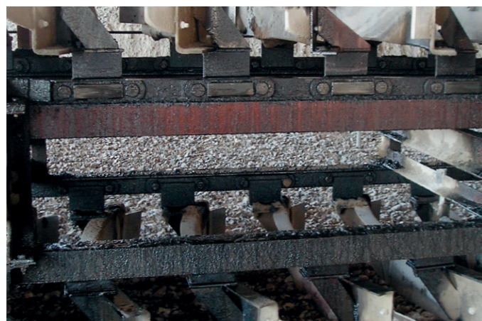
Palettisation de sacs : utilisation de Berulit IKP dans la lubrification de chaînes
