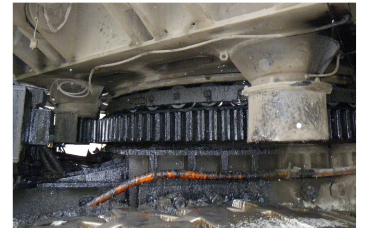
Couronne d'orientation d'un excavateur à roue-pelle lubrifiée avec la Berulit GA 2500
