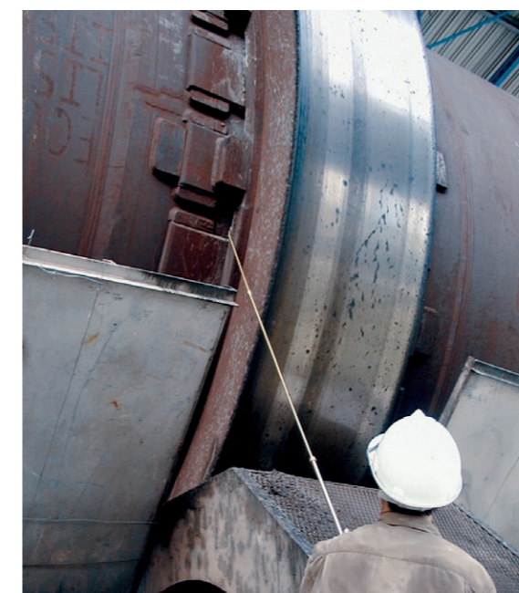
Application de la Berulub VPN 13 Ringlub avec le pulvérisateur BECHEM compression
