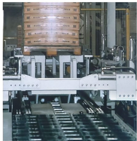
Palettisation de sacs : utilisation de Berulit IKP dans la lubrification de chaînes
