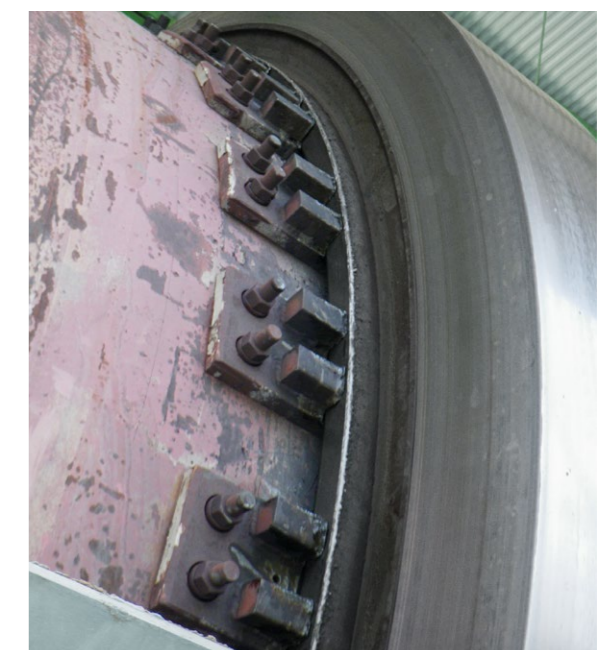
Bague de roulement bien lubrifiée d'un four rotatif
